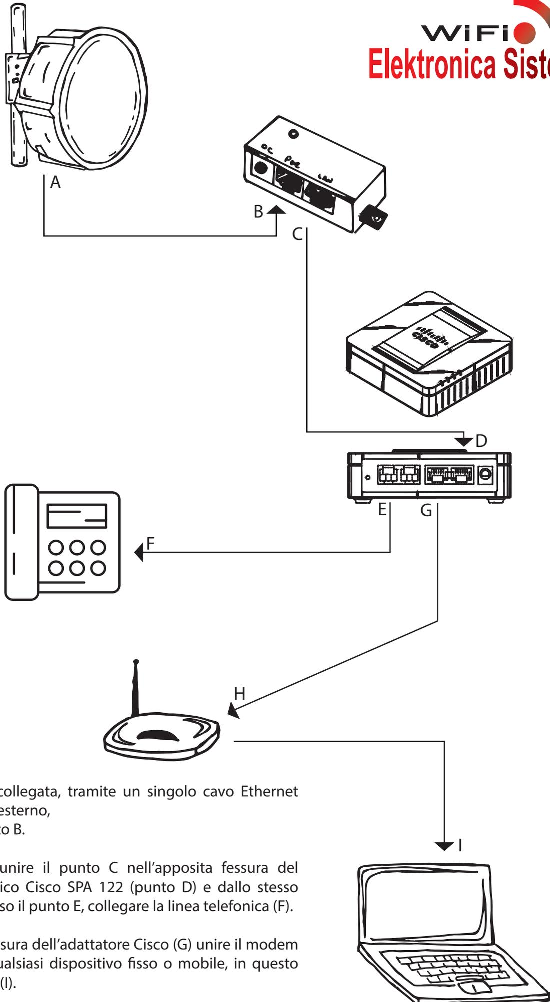
\*L'antenna viene collegata, tramite un singolo cavo Ethernet doppia guaina da esterno, A collegare al punto B.
